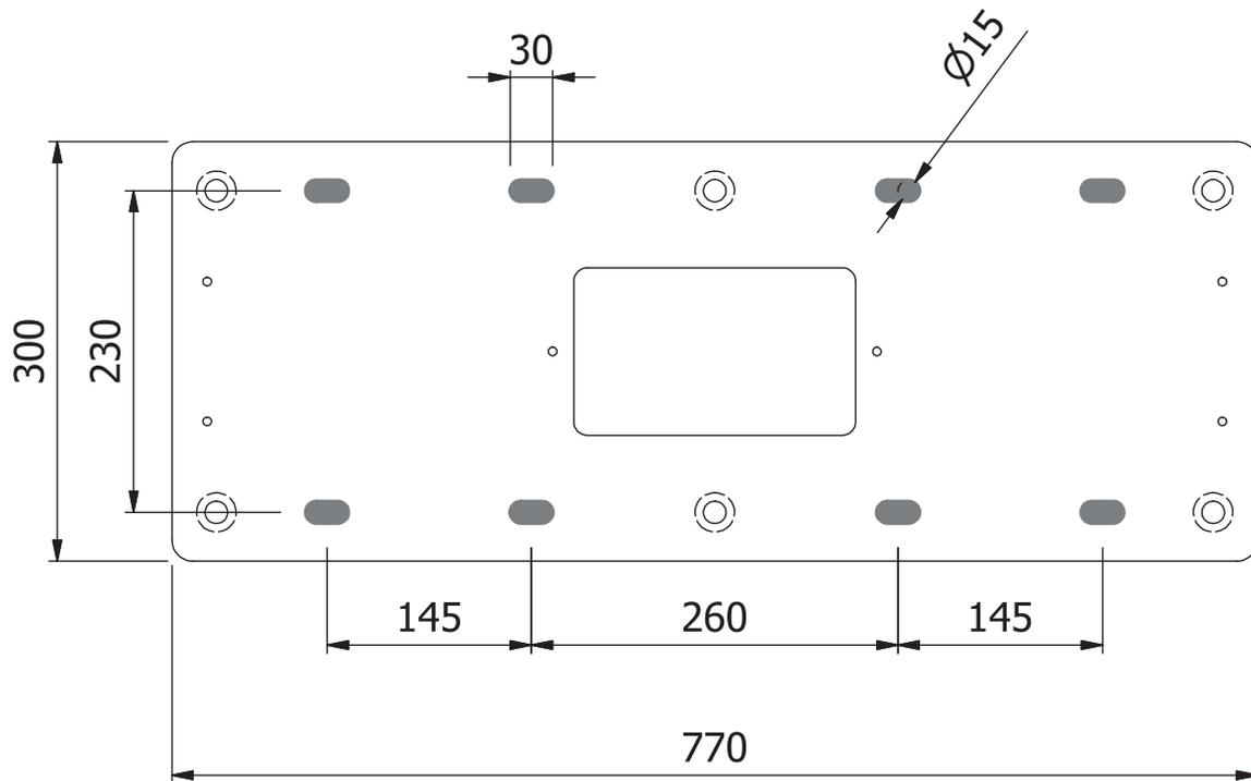
**Standardausführung zur festen Installation mittels eines Fundaments vorgesehen. Stellen Sie sicher, dass die vorbereitet ist.**
